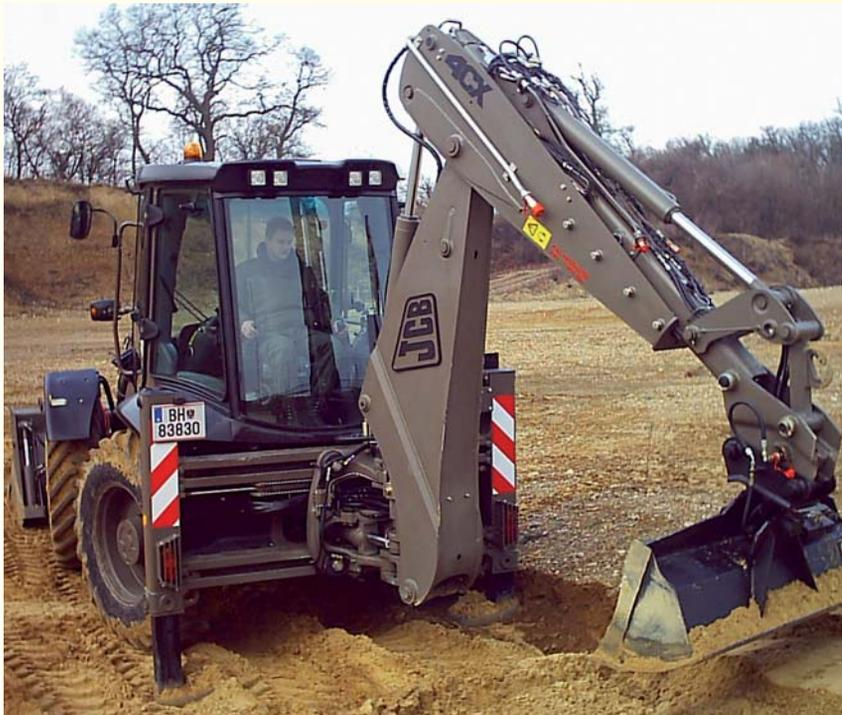
grierten Gabelzinken inklusive zusätzlichem Hydraulikkreislauf ausgestattet, es ermöglicht nach Ablegen der Mehrzweckschaufel mit einem Fassungsvermögen von 1,3 Kubikmeter erstmalig ein Stapeln ohne Einweiser mit direkter Sicht auf die Last.
