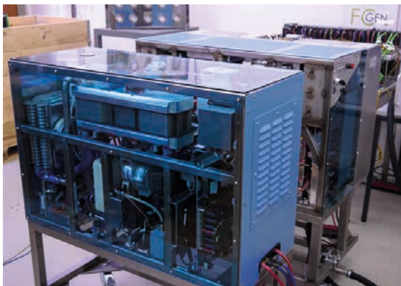
Abbildung 18: APU mit Treibstoffwandler im Hintergrund Quelle: © Europäische Verteidigungsagentur
