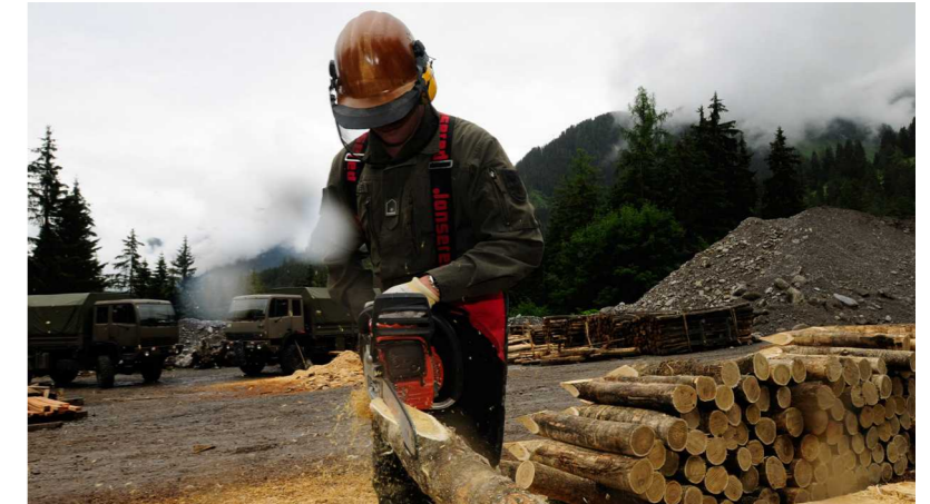
Die Zaunpfähle aus Akazienholz mussten angespitzt werden.
