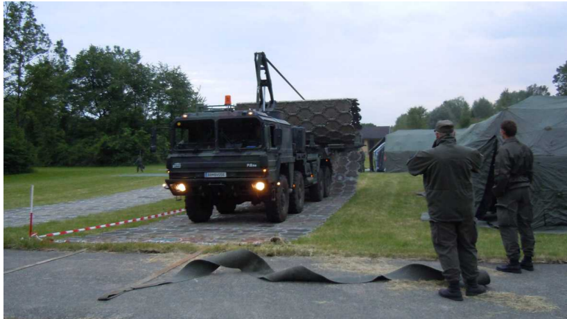
Mit dem Faltstraßengerät wurden notwendige Zufahrten und Verbindungswege geschaffen
