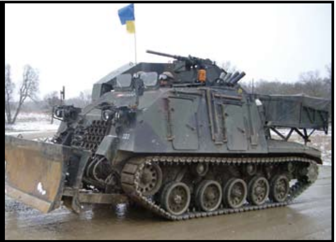
Die Panzerpioniere des Panzerstabsbataillon 3 erhalten den Pi-Panzer mit Räumschild, Tieflöffel, Drehkran und starker Seilwinde
