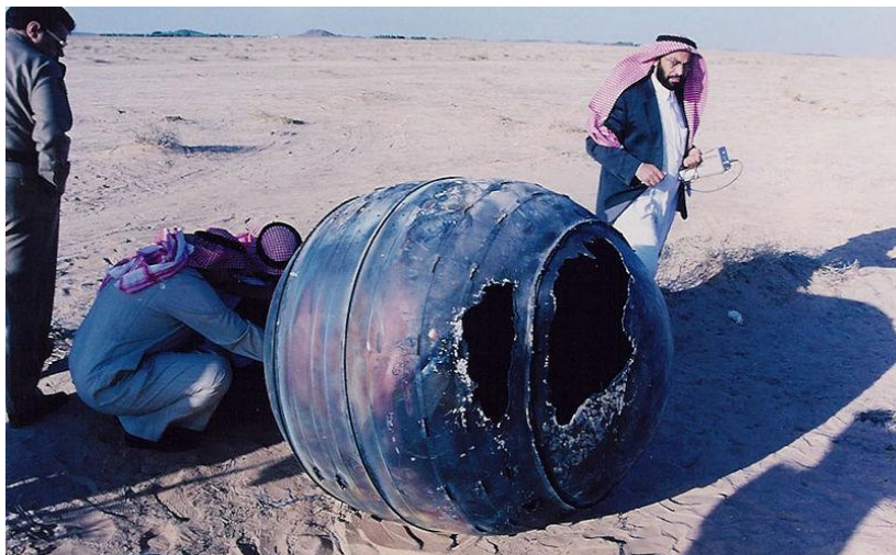
Teil einer amerikanischen Delta-2-Oberstufe, am 21. Jänner 2001 in Saudi Arabien abgestürzt. Foto: NASA
