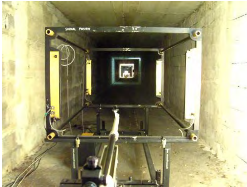
Abb. 4.1: Blick vom eingespannten Versuchsgewehr EVOLUTION (Vordergrund) durch den Messrahmen für die Geschwindigkeitsmessanlage (hier schwarze Rahmenkonstruktion mit dem vorderen und hintern Lichtschranken) in den 300m Schießkanal.
