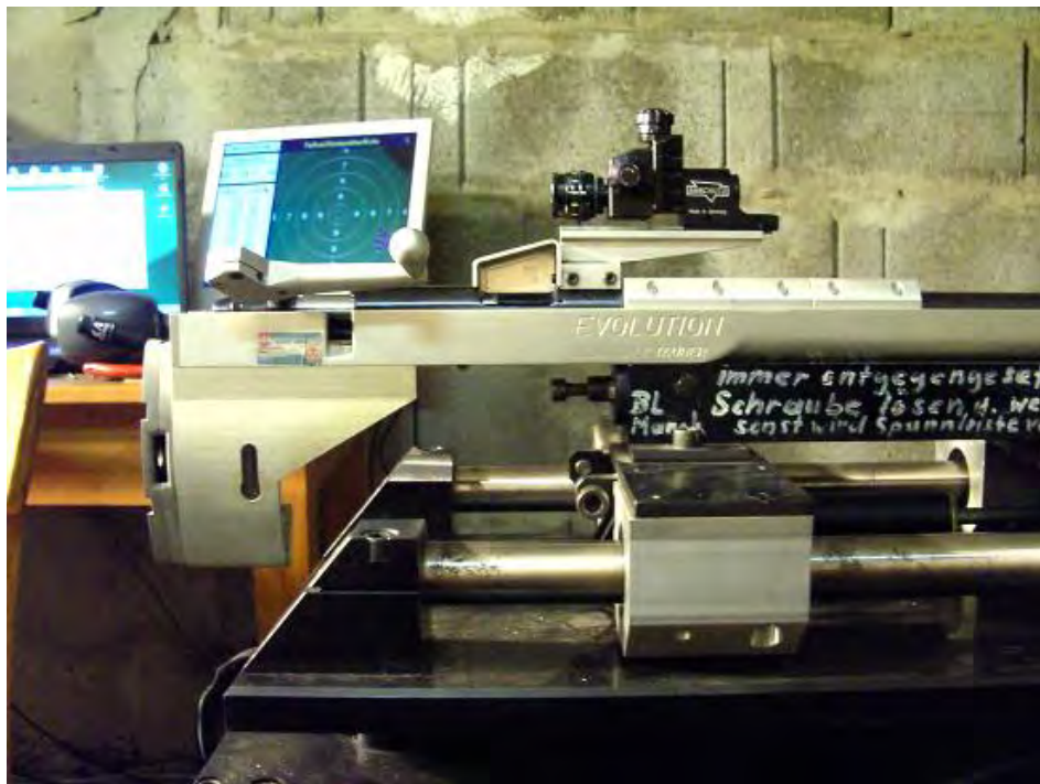
Abb. 4.6: Die hydraulischen Rückstoßdämpfer des HLSZ-Bocks. In der Abbildung ist auch erkennbar, dass vom Versuchsgewehr EVOLUTION einige Bauteile, wie z.B. der Abzug, die Schaftkappe und die Backe, abmontiert sind, um einen rascheren Bettungsumbau zu ermöglichen.
