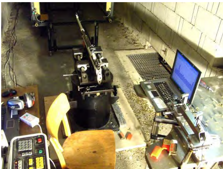
Abb. 4.5: Das Versuchsgewehr EVOLUTION eingespannt in den „Standardbock“ des HLSZ. Erkennbar ist auch die Holzplatte auf der der Bock steht.
