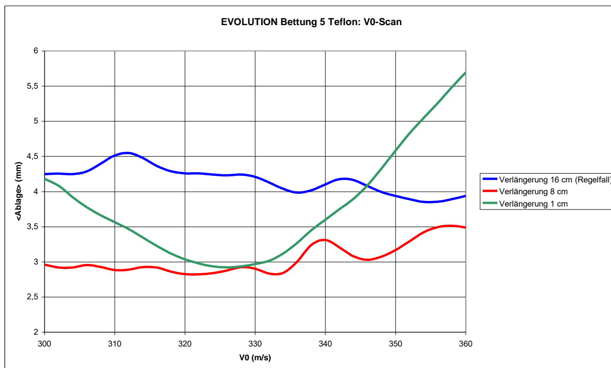
Abb. 5.36: Versuchsgewehr EVOLUTION mit Bettung 5/Teflon; v_0 -Scan für drei verschiedene überkalibrige Laufverlängerungen.
