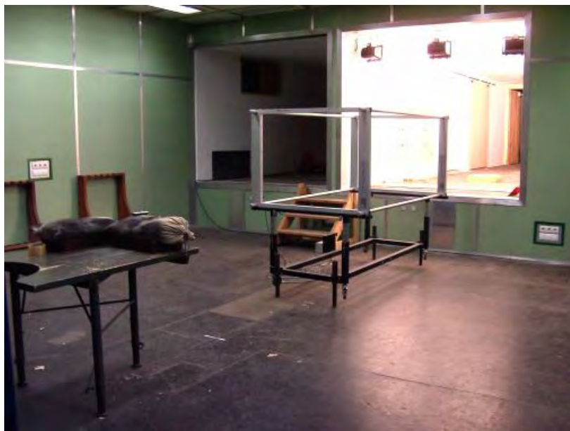
Abb. 4.2: Der Expansionsraum mit einem weiteren Geschwindigkeitsmessrahmen. Links der Beginn des 300 m Kanals und rechts, beleuchtet, der Anfang des 500 m Schiesskanals.
