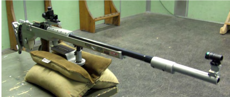
Abb. 2.2: Das Versuchsgewehr EVOLUTION. Gut erkennbar das relativ große Überrohr aus Aluminium montiert an der Laufmündung (Lauf in schwarzer Farbe)
