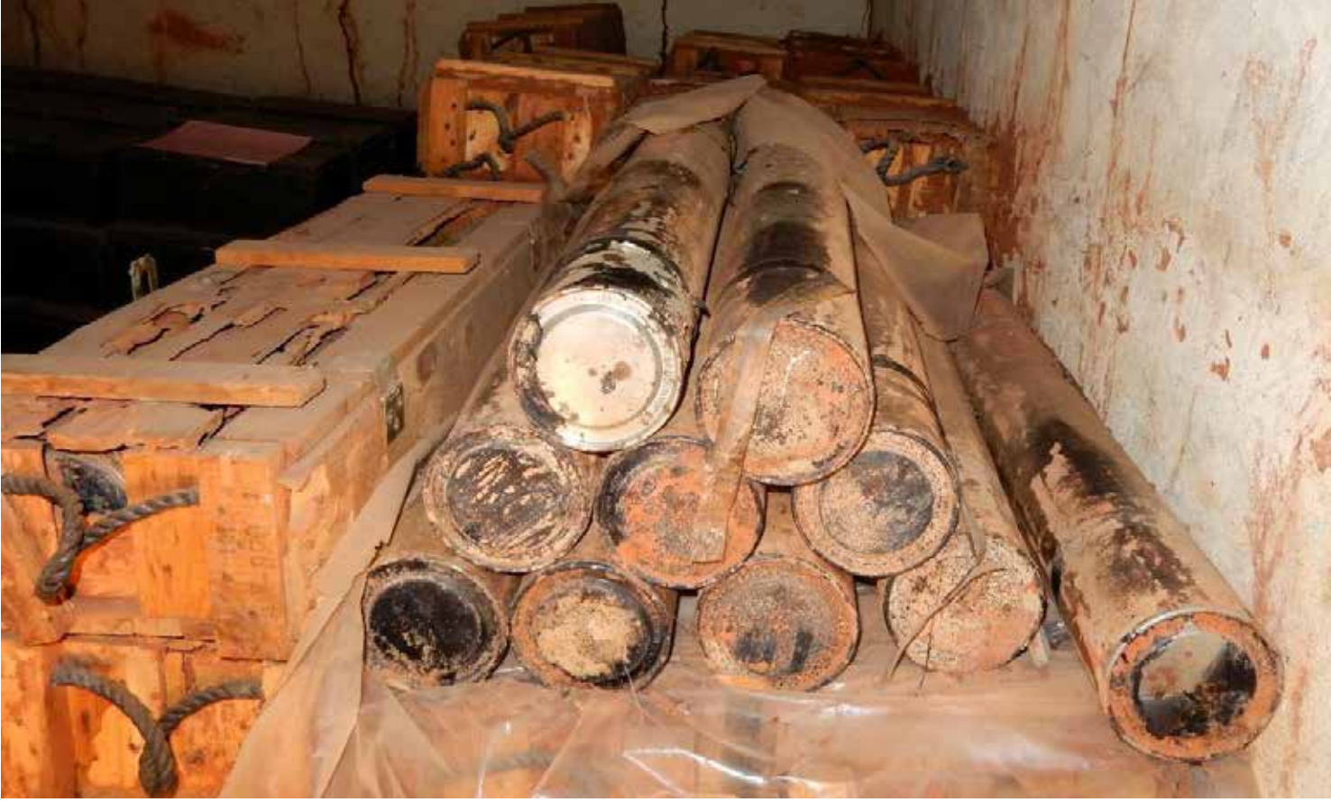
Lagermissstände als ein Hauptgrund für ungeplante Explosionen
