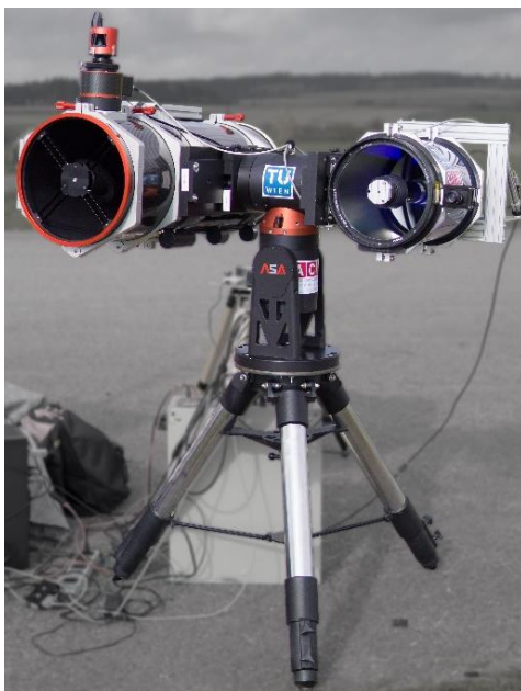
Abbildung 1: Automatisches Teleskopsystem zur Detektion von Drohnen.
