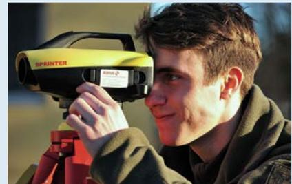
Das digitale Nivellierinstrument kommt unter anderem beim Brückenbau zum Einsatz. Der Vermessungstrupp kann damit die vermessungstechnische Erkundung, Vorbereitungsarbeiten und die Endkontrolle der Brücke millimetergenau genau durchführen und alle Daten elektronisch dokumentieren.
