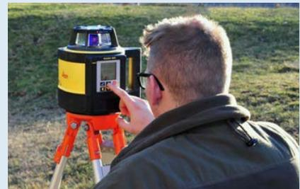
Ein Rotationslaser erzeugt mittels eines Laserstrahles eine waagrechte Ebene, an der sich die Baumaschinen, welche mit Laserempfängern ausgestattet sind, orientieren können. Dadurch können großflächige Erdbauarbeiten schneller, genauer und mit weniger Personal erledigt werden.
