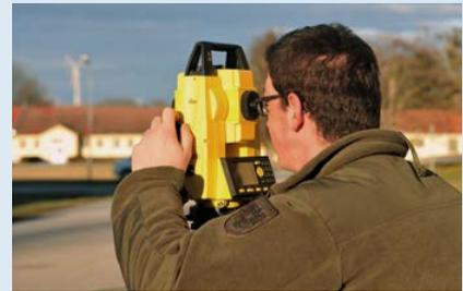
Mit den neuen elektronischen Theodoliten kann ein Bauplatz zentimetergenau aufgenommen werden und nach der Planung am Computer werden alle Komponenten eines Feldlagers wie Unterkünfte, Hubschrauberlandeplätze, Energieversorgungsanlagen, Wasseraufbereitung, Sicherungstürme etc. ebenso genau im Gelände platziert.
