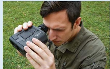
Für Erkundungsaufgaben wie im Katastropheneinsatz oder für den Brücken- oder Seilbahnbau stehen Laserentfernungsmesser zur Verfügung, mit denen Hindernisse schnell und genau vermessen werden können.
