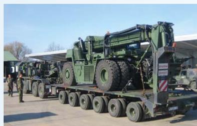
ten Reihe geeignet. Bei 15 Grad Seitenneigung und bei 30 Grad Steigung kann dieses Fahrzeug einen 24 Tonnen Container manipulieren. Verglichen mit einem Autokran, der nur auf einem geraden Untergrund abgestützt und nivelliert werden muss, bis dieser einsatzbereit ist und auch nur einen beschränkten Manipulationsbereich bedienen kann, stellt dies eine drastische Verbesserung des aktuellen Ist-Zustands dar. Einen weiteren wesentlichen Vorteil stellen die Ausbildungs-
