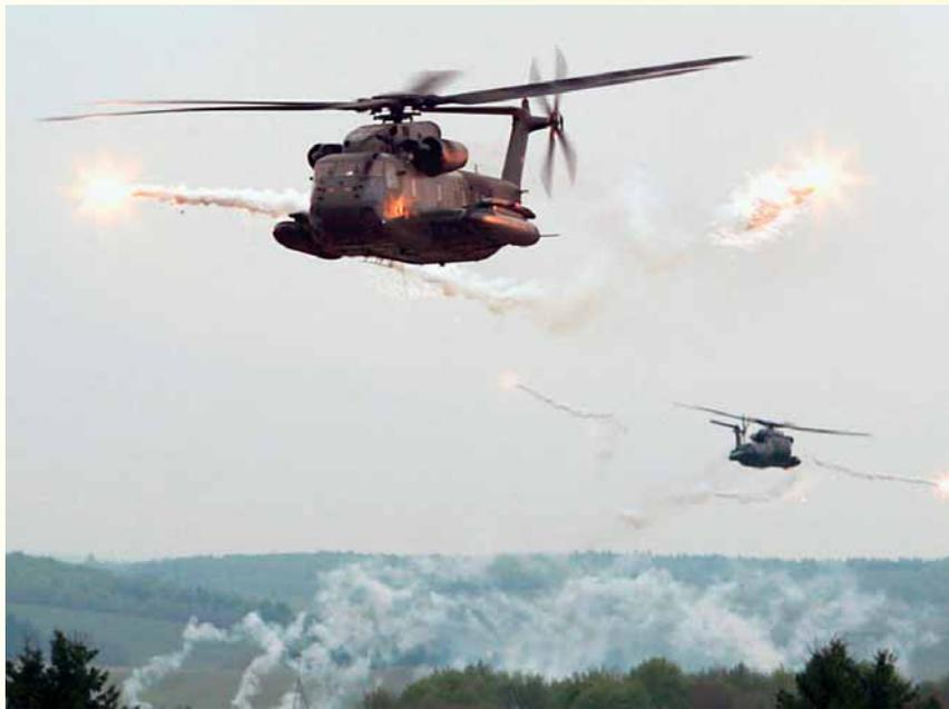
erkennen und automatische Abwehrmaßnahmen (Ausstoß von Leuchtfackeln) durchzuführen. Ziel dieser Maßnahmen ist es, den Suchkopf der Lenkwaffe zu stören oder zu täuschen und dadurch eine Zielverfolgung zu verhindern. Selbstschutzausrüstungen erhöhen die Überlebensfähigkeit und ermöglichen die Erfüllung des Auftrages. Für die Besatzung stellen sie die „Rückfahrkarte“ dar.
