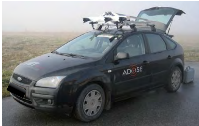
Abbildung 33: Fahrzeug mit Sensorausstattung zur Geländeaufnahme im Testgelände
