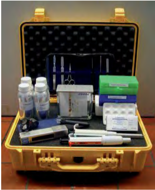
Abbildung 27: EAS-07: Koffer für die einfache Explosivstoffanalyse im Feldeinsatz
