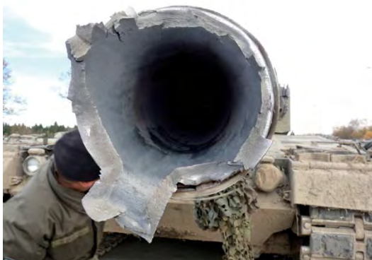
Abbildung 9: Abgerissenes 120mm Waffenrohr von vorne
