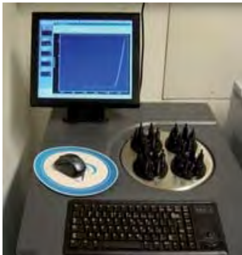
Abbildung 25: Wärmeflusskalorimeter zur Stabilitätsprüfung von Treibladungspulvern
