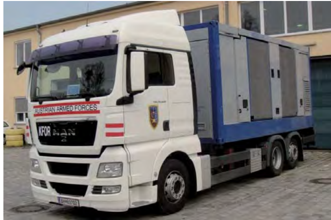
Abbildung 36: Mobiler Prüfstand am WAB-LKW verlastet
