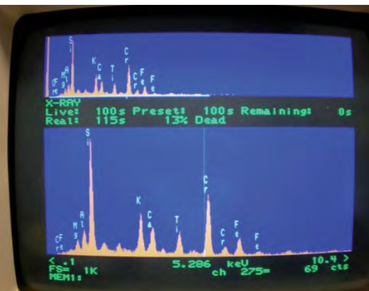
Abbildung 12: Siliziumreiches RDX-Spektrum des braunen Belags
