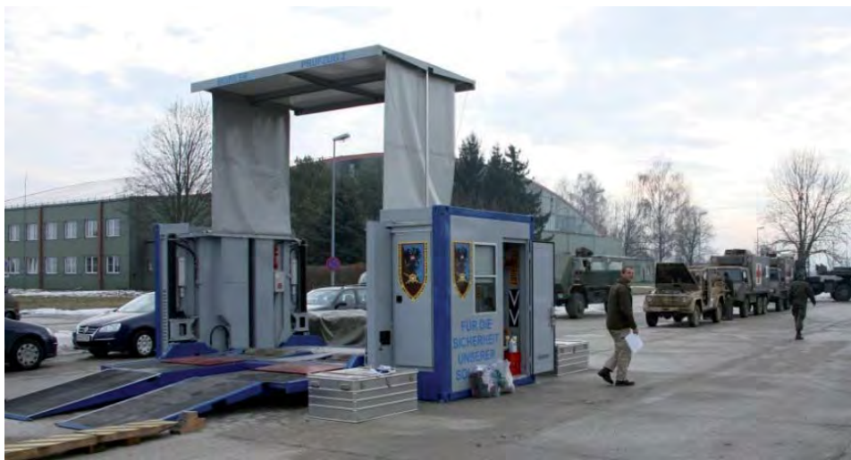
Abbildung 39: Mobiler Prüfstand mit zu prüfenden Fahrzeugen
