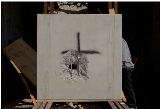
Abbildung 18: Durchschlagsleistung der 30mm Mehrzweckmunition (SPz Ulan) ...
