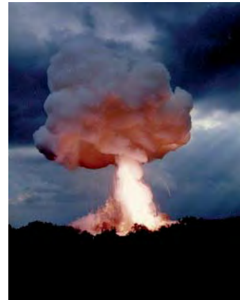
Abbildung 24: Wirkung der Explosion von 1500kg Treibladungspulver im Freien
