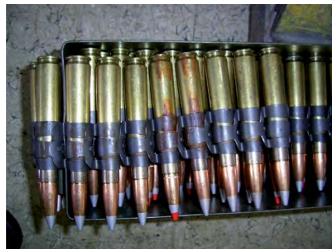
Abbildung 16: Korrosion an Munition
