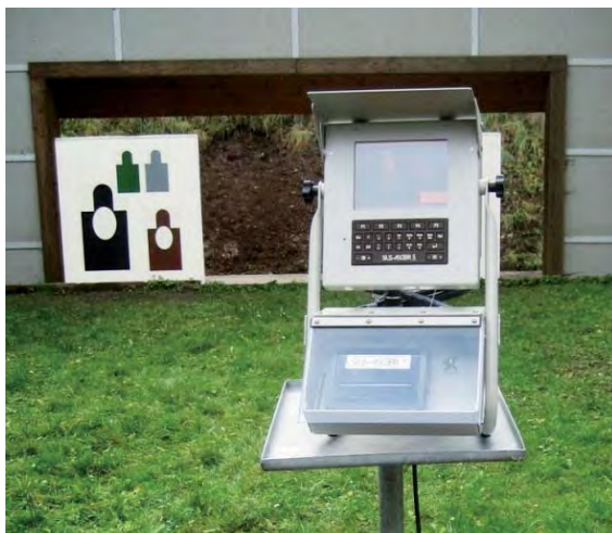
Abbildung 63: SIUS 9003 mit skalierten Zielbildern für unterschiedliche gedachte Entfernungen
