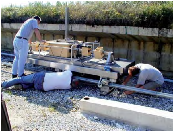
Abbildung 59: Technische Güteprüfung einer Scheibenzuganlage mit Panzerklappziel
