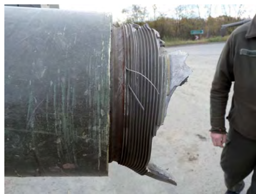
Abbildung 10: Abgerissenes 120mm Waffenrohr von der Seite
