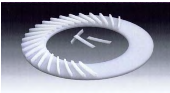
Abbildung 44: Schema der Bremsscheibe mit Turbinendesign zur Verbesserung der Innendurchlüftung
