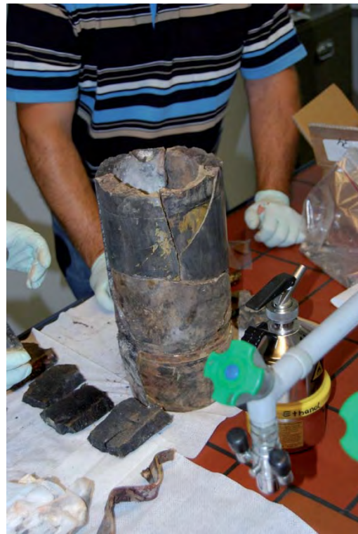
Abbildung 17: Rekonstruktion von Munition zur Ursachenermittlung nach einem besonderen Vorfall
