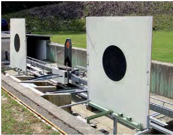
Abbildung 61: Typische Schießanlage mit Laufziel, Reaktionszielen und Ziele mit offenem Messsystem für Schulschießen mit StG 77
