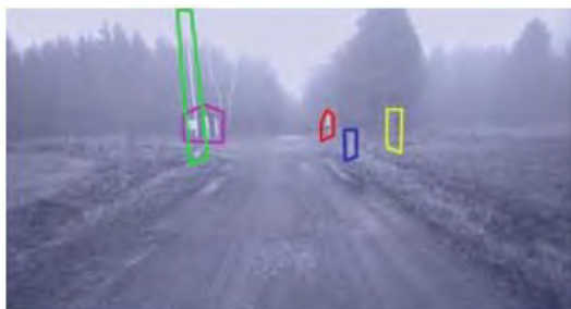
Abbildung 34: Identifikation von Hindernissen durch den Autonomie-Algorithmus
