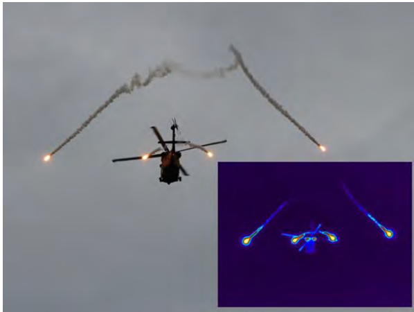
Abb. 58: Black Hawk UH-70 beim Ausstoß von pyrotechnischen Flares; eingeblendet ist das thermografische Bild
