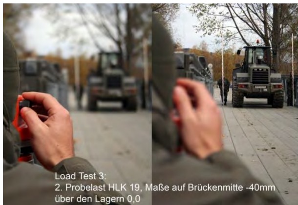
Abb. 35: Belastungstest auf Brücken
