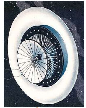
Abbildung 3: K. u. k. Oberleutnant Hermann Potočnik (Noordung) und sein Entwurf des „Wohnrads“ im geostationären Orbit, das zur Erzeugung künstlicher Schwerkraft permanent rotieren sollte, ein Kraftwerk enthielt, das über Parabolspiegel Energie aus der Sonnenstrahlung gewinnen sollte, und auch ein Observatorium aufwies (Quelle: Wikipedia) [9]
