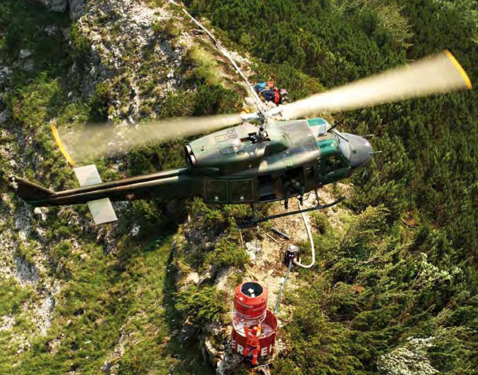
*Eine Agusta Bell AB-212 nimmt Wasser zur Bekämpfung eines Waldbrandes auf. Im unwegsamen Gelände ist der Hubschrauber oft das einzig verfügbare effektive Transportmittel für Löschwasser.*
