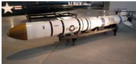
Abbildung 15: Amerikanische Anti-Satellitenrakete, die von einer F-15 Eagle in den Orbit geschossen wird
