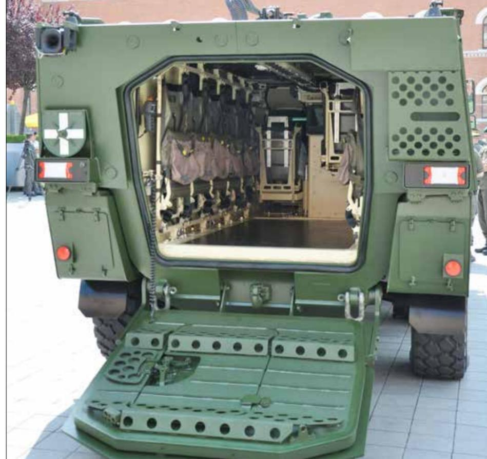
Der EVO von hinten. Er ist mit einer hydraulischen Heckrampe und integrierter Notausstiegs Luke ausgestattet. Ein Schienensystem ermöglicht einen schnellen Umbau des Innenraumes.
