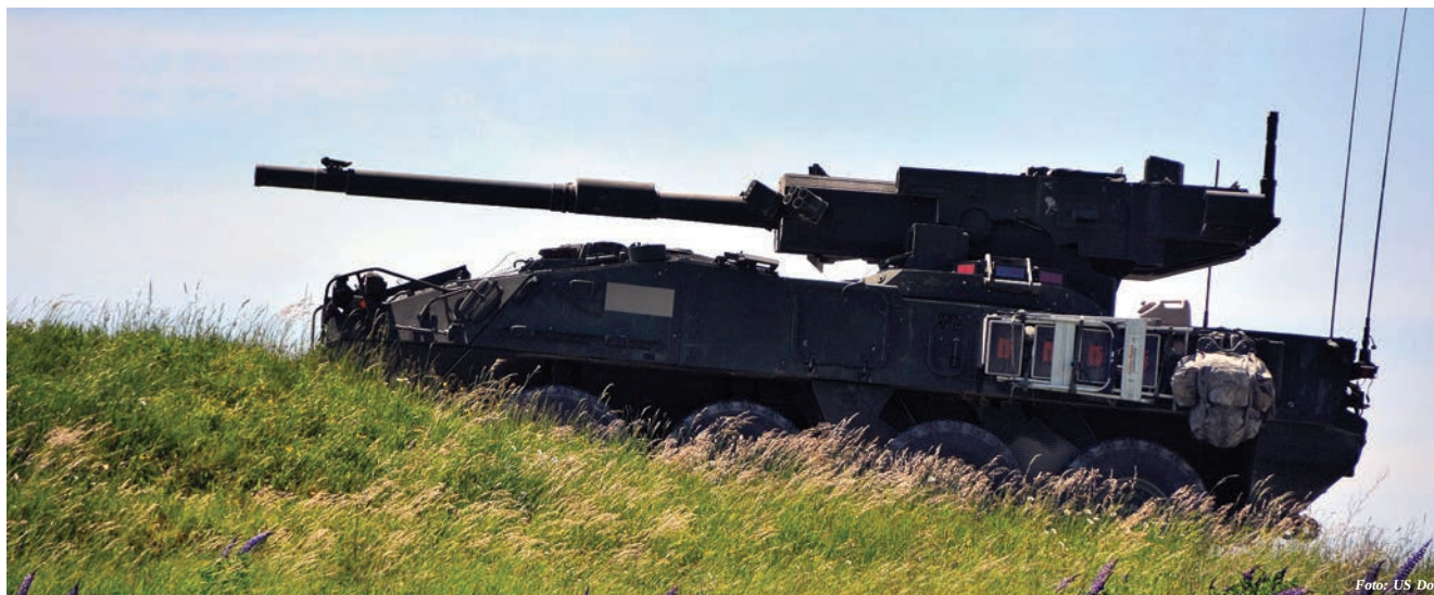
Das „Stryker Mobile Gun System“ M1128 hat eine 105-mm-Kanone als Hauptwaffe.
