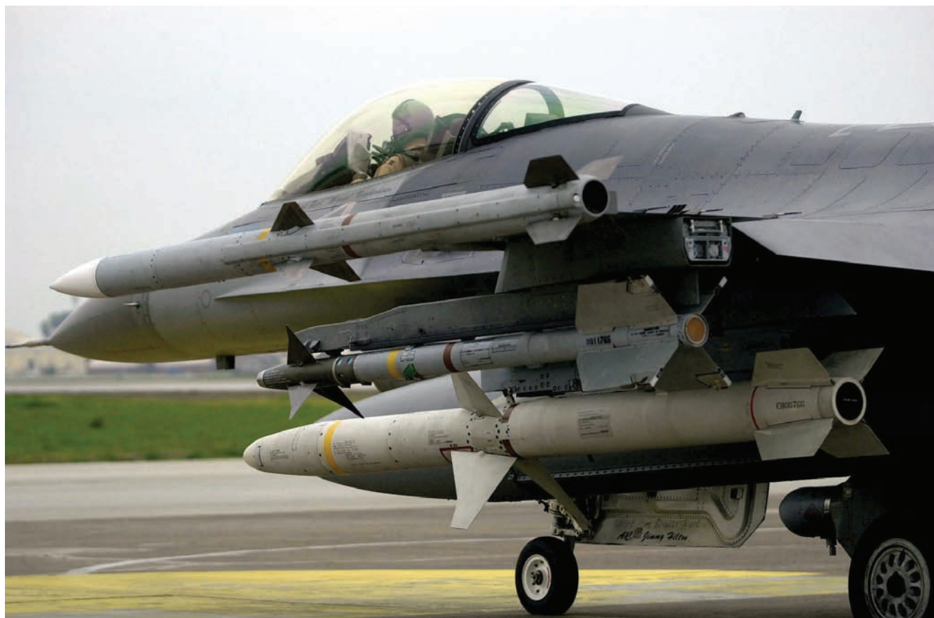
F-16 mit den Lenkflugkörpern AIM-120 AMRAAM (oben), AIM-9 „Sidewinder“ (mitte) und AGM-88 (unten).
